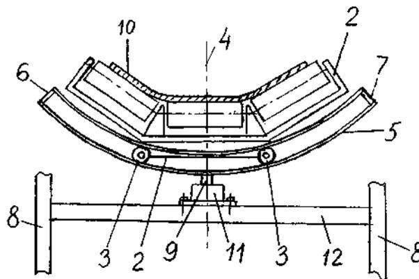
возможностью смещения и фиксации на горизонтально ориентированной поперечной балке (12) рамы конвейера. Повышается эффективность центрирующего устройства. 1 ил.
