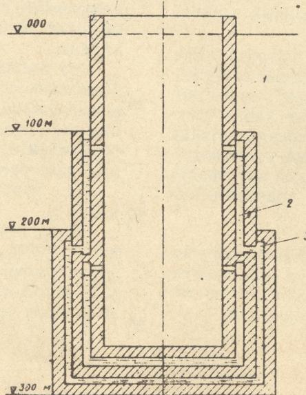
На внешнюю поверхность третьего участка максимально возможная нагрузка составляет  $300 \text{ t/m}^2$ , однако, учитывая противодавления в компенсационных пазах, все тюбины испытывают нагрузку, не превышающую их несущую способность. Таким образом, на любой глубине максимальная нагрузка не превышает  $100 \text{ t/m}^2$ .
