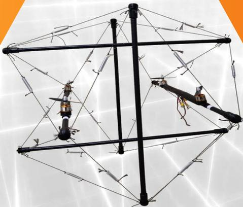
**Оснащение беспилотного летательного аппарата (квадрокоптера) амортизирующим защитным каркасом для обеспечения безопасности полетного оборудования от внешнего контакта во время испытательных полетов при разработке или выполнения работ на промышленных и гражданских объектах.**
